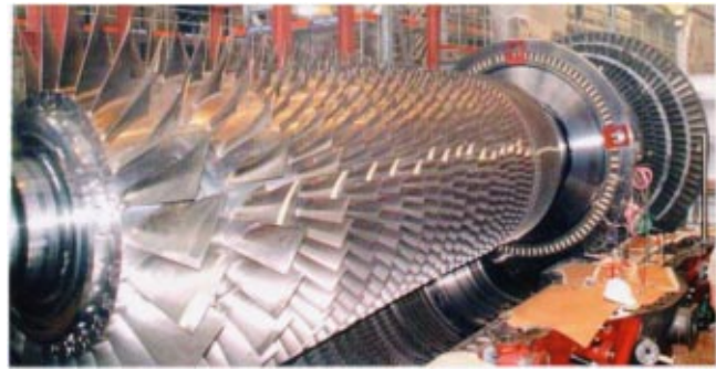
Fig. 15 GT 24/GT 26 rotor turbocomponents
